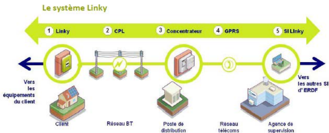
Figure 21 : illustration du fonctionnement du réseau de télé-relève d'Enedis
