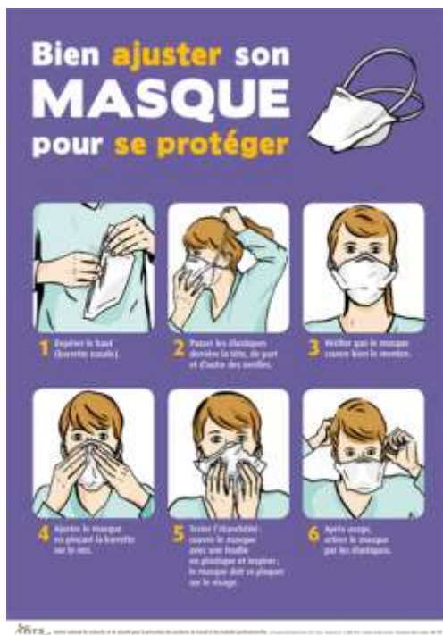
Figure 10 — Exemple d'affiche décrivant la mise en place du masque et le contrôle d'étanchéité (INRS : http://www.inrs.fr/media.html?refINRS=A%20759 )
